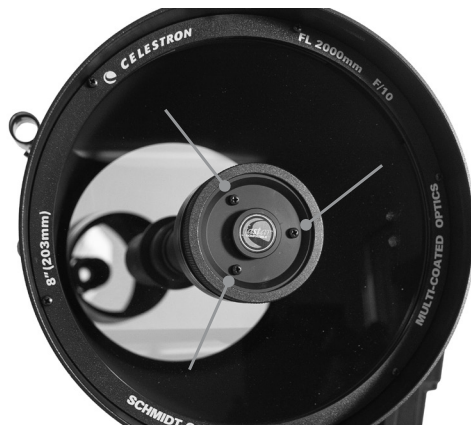
Collimazione dello specchio secondario regolando le viti
