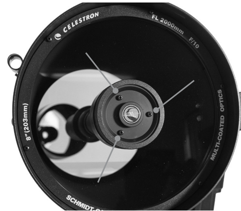
Vis de collimation du miroir secondaire
