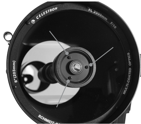
Tornillos de ajuste de colimación del espejo secundario
