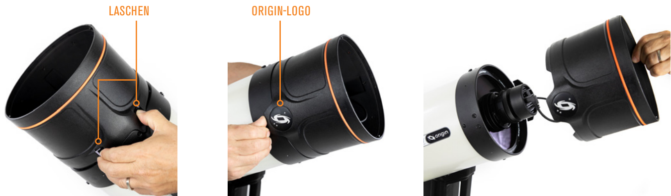
Abb. 13: Entfernen Sie die Taukappe, indem Sie mit einer Hand auf die beiden LASCHEN drücken und gleichzeitig das Origin-Logo nach oben schieben.
