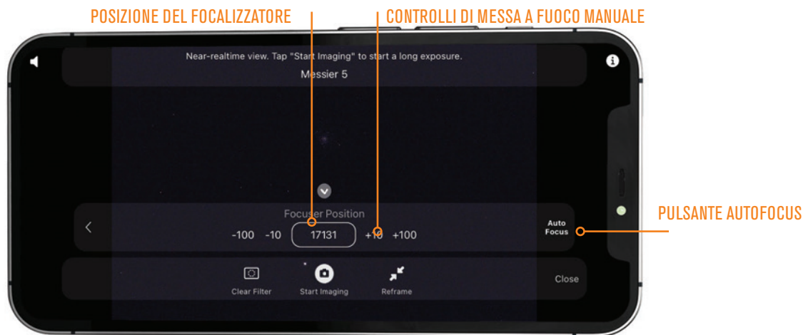
Fig. 12: Utilizza l'icona di messa a fuoco per accedere ai controlli di messa a fuoco automatica e manuale. Anche la posizione del focalizzatore può fornire informazioni utili.
