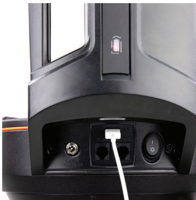
FIG. 38: È possibile utilizzare la porta di ricarica USB sul supporto Origin per caricare il proprio dispositivo sul campo.
