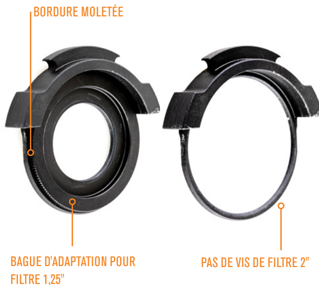
Fig. 16: Retirez l'anneau adaptateur de filtre de 1,25" du tiroir pour exposer les filetages du filtre de 2".
