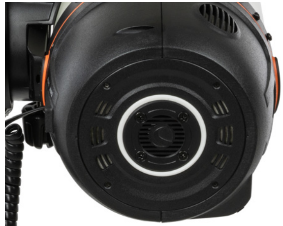
Fig. 8: L'anello LED sulla cella posteriore di Origin fornisce lo stato a colpo d'occhio.
