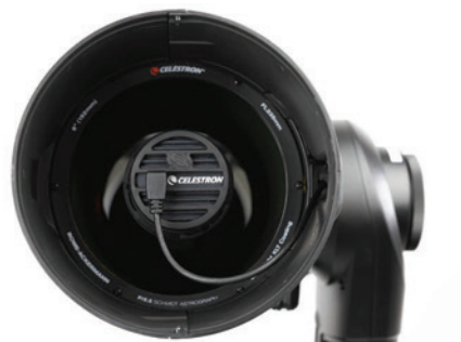
FIG 29: El fotograma plano tomado en fábrica y precargado en Origin se capturó con la cámara en la orientación mostrada. Si rota la cámara a una orientación distinta, deberá producir un nuevo fotograma plano.
