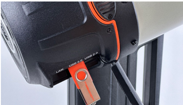
ABB. 27: Stecken Sie einen USB-Stick in den USB-Anschluss des Tubus, um die Rohbilddateien zu übertragen.
