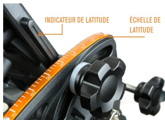
FIG D2: Tournez la molette de réglage de la latitude de la cale jusqu'à ce que l'indicateur de latitude soit aligné avec la latitude de votre position actuelle sur l'échelle.
