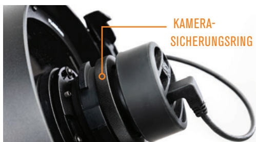
ABB. 30: Wenn Sie die Kameraausrichtung drehen möchten, lösen Sie zuerst den Kamera-Sicherungsring.
