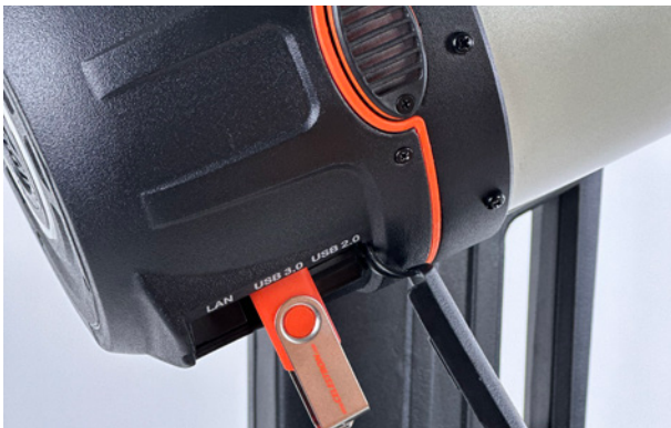
FIG 27: Inserte una unidad USB en el puerto USB del tubo de Origin para transferir los archivos de imagen raw.
