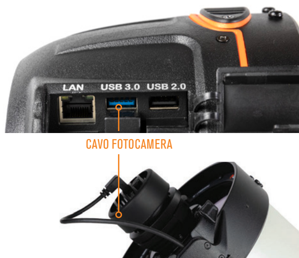
FIG. 36: Una estremità del cavo della fotocamera si collega alla fotocamera. L'altra estremità si collega a una delle porte USB di Origin.
