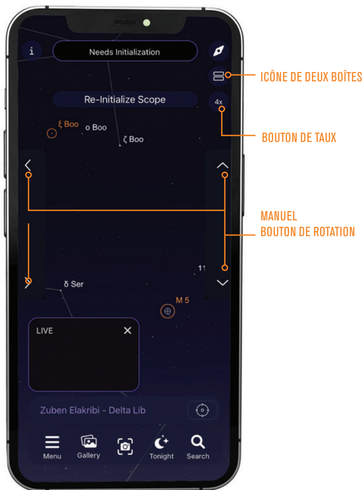
Fig 24 Afficher les commandes de portée vous donne des commandes de rotation manuelles dans la vue du planétarium. Utilisez le bouton Rate pour modifier la vitesse de balayage.
