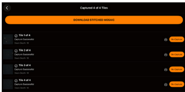
FIG I5: Acquisire nuovamente un pannello tramite il pulsante Acquisisci di nuovo a destra del pannello. Scaricare un pannello nell'app toccando l'icona download a destra del pannello.
