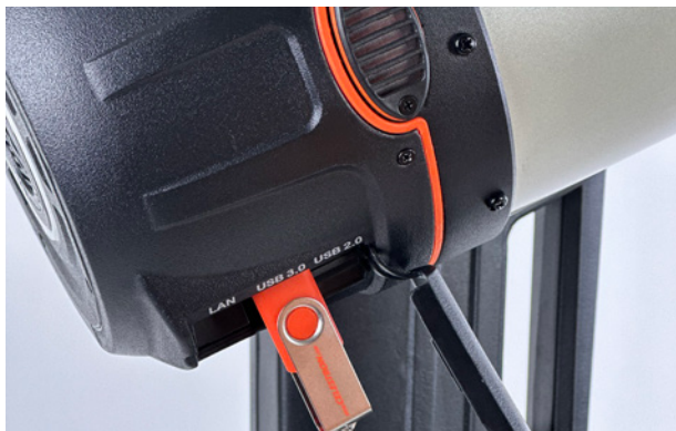
FIG. 27: Inserisci una chiavetta USB nella porta USB sul tubo di Origin per trasferire i file di immagine grezza.
