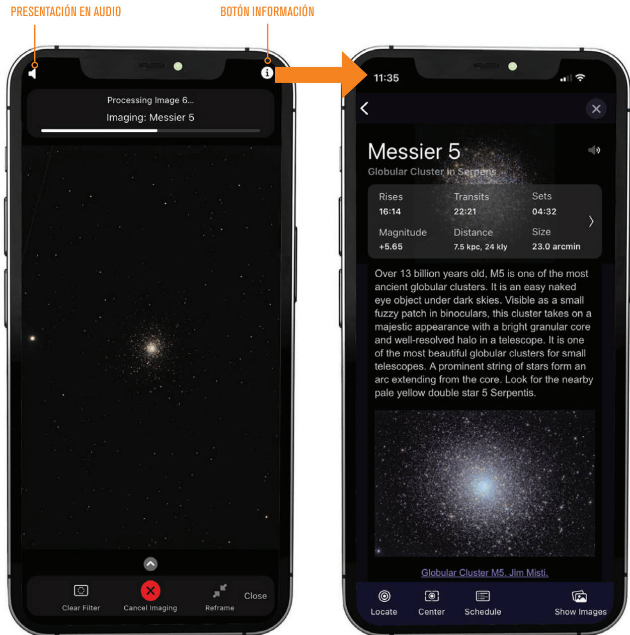
Fig. 7: Durante la captura de imágenes puede leer información de su objeto elegido o escuchar una presentación en audio usando los iconos de las esquinas superior izquierda y superior derecha.
