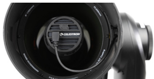
ABB. 29: Der im Werk aufgenommene und auf Origin vorgeladene Flat-Frame wurde mit der Kamera in der gezeigten Ausrichtung aufgenommen. Wenn Sie die Kamera aus dieser Ausrichtung herausdrehen, müssen Sie einen neuen Flat-Frame erstellen.
