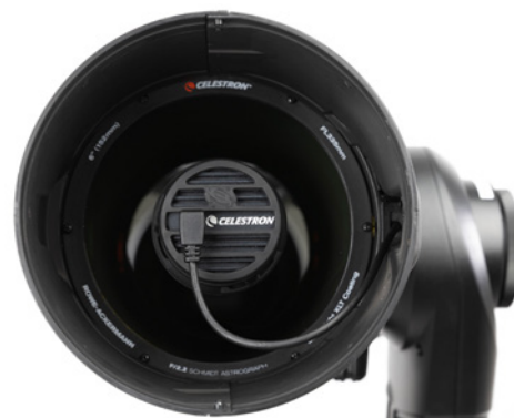
FIG. 29: Il flat frame acquisito in fabbrica e precaricato su Origin è stato catturato con la fotocamera nell'orientamento mostrato. Se ruoti la fotocamera da questo orientamento, dovrai produrre un nuovo flat frame.
