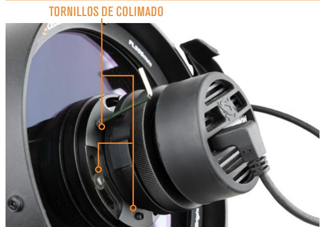
FIG 34: Ajuste la inclinación del grupo de lentes (y la cámara) con los tornillos de colimado.
