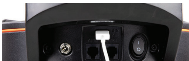
FIG 38: Puede usar el puerto de carga USB en el soporte Origin para cargar su dispositivo en el campo.
