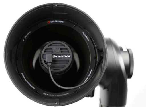
FIG. 29: Il flat frame acquisito in fabbrica e precaricato su Origin è stato catturato con la fotocamera nell'orientamento mostrato. Se ruoti la fotocamera da questo orientamento, dovrai produrre un nuovo flat frame.
