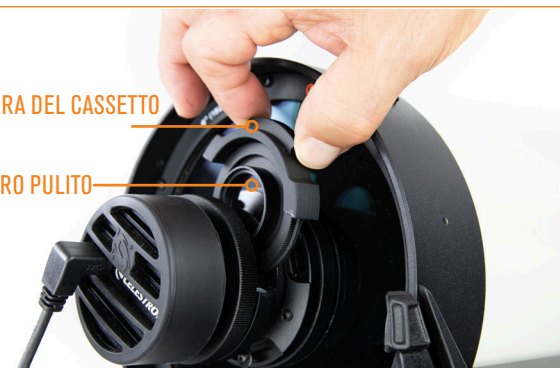
Fig. 15: Afferrare l'impugnatura del cassetto con le dita e tirare verso l'esterno per liberarlo dai magneti.
