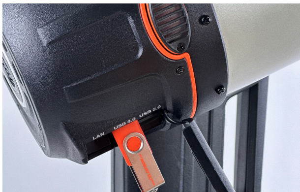
ABB. 27: Stecken Sie einen USB-Stick in den USB-Anschluss des Tubus, um die Rohbilddateien zu übertragen.
