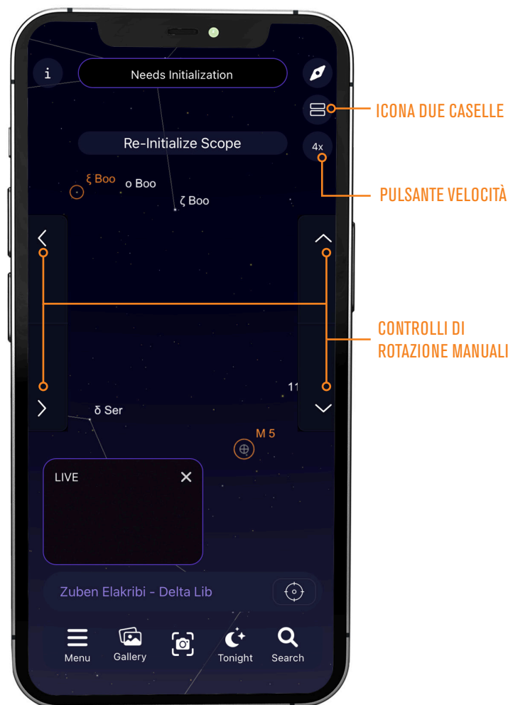
FIG. 24: Mostra controlli telescopio offre controlli di rotazione manuali nella Vista Planetario. Utilizzare il pulsante Velocità per modificare la velocità di rotazione.
