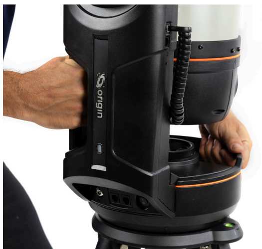
Fig 31 Utilisez les poignées du bras de fourche et du support pour soulever l'Origin.
