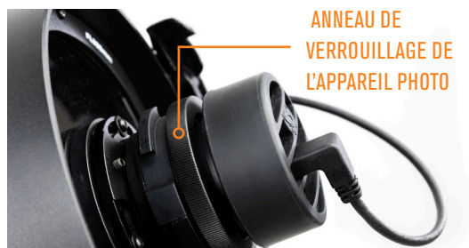
Fig 30 Si vous souhaitez faire pivoter l'orientation de la caméra, desserrez d'abord la bague de verrouillage de la caméra.
