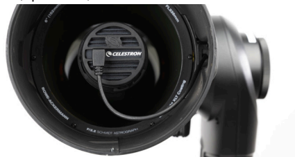
Fig 29 Le cadre plat pris en usine et préchargé sur Origin a été capturé avec l'appareil photo dans l'orientation indiquée. Si vous faites pivoter la caméra à partir de cette orientation, vous devrez produire un nouveau cadre plat.
