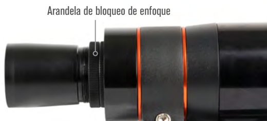
Fig. 22: Afloje la arandela de bloqueo cuando realice ajustes de enfoque, y apriétela firmemente cuando esté enfocado.
