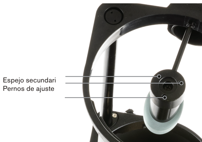
Fig. D: Ubicación de pernos de ajuste del espejo secundario
